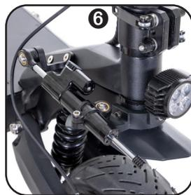
Zum Schluss stellen Sie den Lenker ganz nach links und ziehen Sie dann die Stellschraube **9** fest an. An dem Stellerad oberhalb des Lenkungsdämpfers lässt sich nun die Stärke einstellen.
